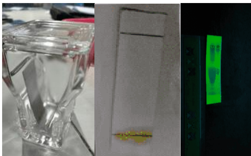
Gambar 1 Uji KLT eugenol minyak cengkeh dengan pelarut etanol dan eter
